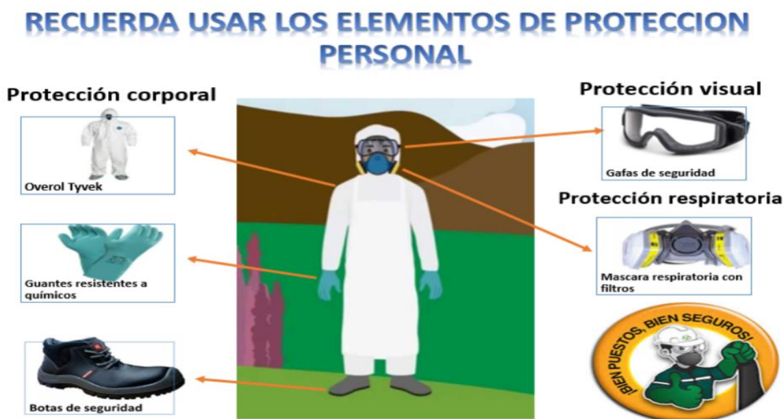
Figura 6. Elementos de protección personal requeridos para procesos de fumigación y desinfecciones exhibida en área operativa
